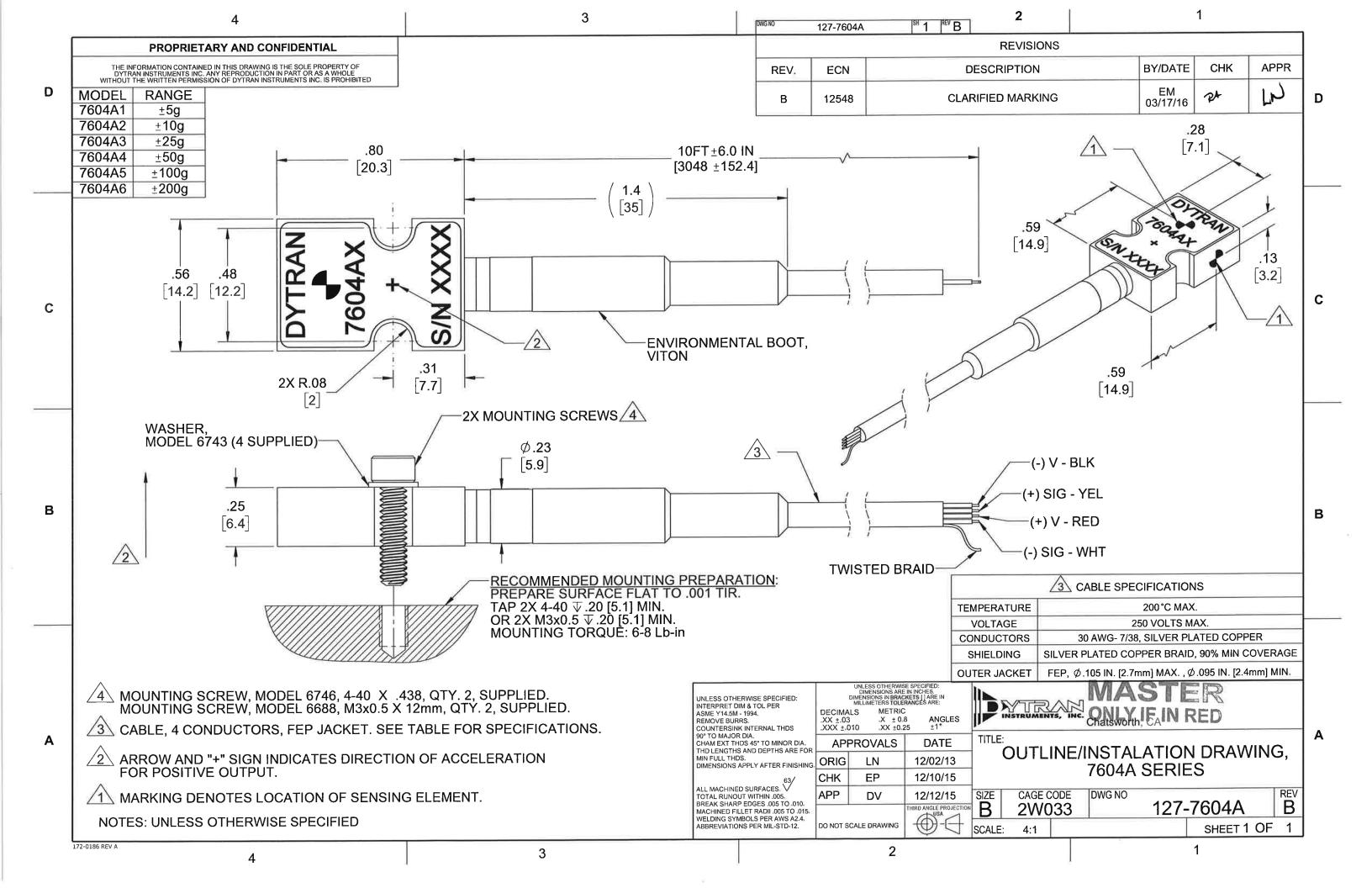
Model Number DOC NO PERFORMANCE SPECIFICATION 7604A1 PS7604A1 VARIABLE CAPACITANCE ACCELEROMETER REV G, ECN 15839, 08/07/20
