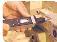
ตรวจสอบโซลินอยด์ตัวว
