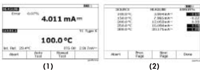
รูปที่ 10 (1) Fluke 753/754 Documenting Process Calibrator สามารถแสดงผลพร้อมกันบนจอ และรูปที่ 10 (2) สามารถคำนวณ % Error และบอกการผิดพลาดเกินกำหนดที่จุดสอบเทียบได้ด้วย
