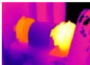
ความร้อนสูงเกินที่แบร์ริง จาก ปัญหาติดตั้งและการหล่อลื่น
