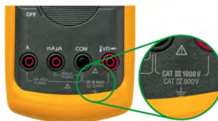
รูปที่ 7 มาตรฐานความปลอดภัย EN-61010-1 Category III ที่สามารถรองรับการใช้งานในระบบไฟฟ้าได้อย่างครอบคลุมทุกสถานการณ์
