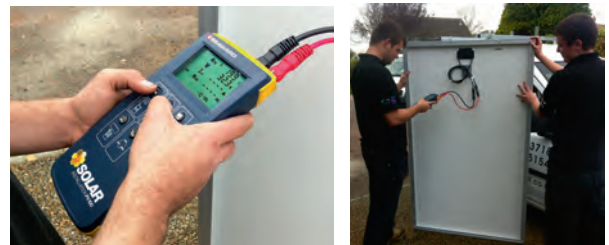
การตรวจสอบความพร้อมของแผง PV Solar Cell ด้วยเครื่องมือของ Seaward
