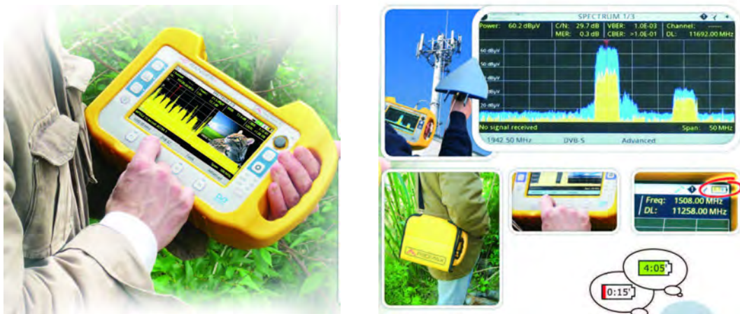
ตัวอย่างหน้าจอการวัด LTE INGRESS TEST
