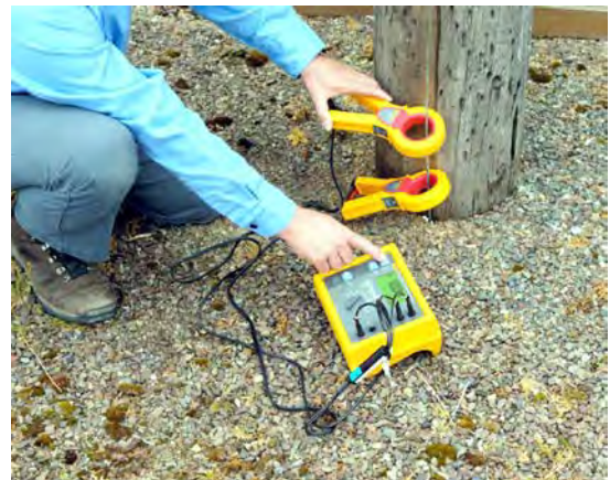
การตรวจวัดระบบกราวด์ (Earth Ground Resistance)
