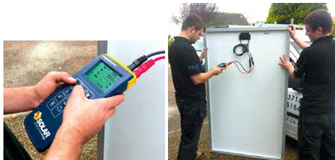
การตรวจสอบความพร้อมของแผง PV Solar Cell ด้วยเครื่องมือของ Seaward
