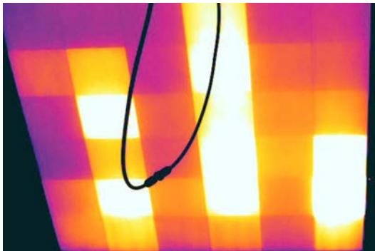
ภาพความร้อนจากแผงโซลาร์เซลล์ด้านล่าง
