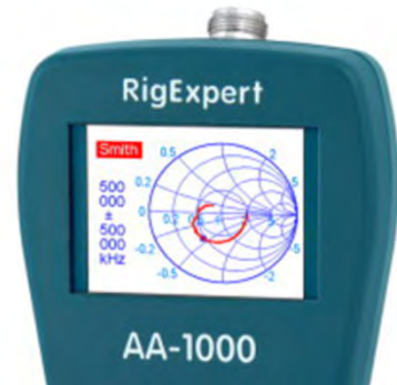
RigExpert AA-1000 สามารถแสดงผลรูป Smith Chart สำหรับช่วยในการปรับแต่งสายอากาศได้โดยง่าย
