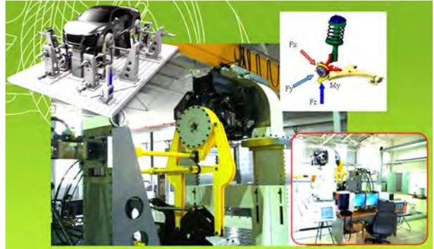
เครื่องทดสอบชุดช่วงล่างรถยนต์ (ประกอบด้วย ล้อและยางรถยนต์ ดุมและลูกปืน ระบบเบรก คอม้า ปีกนก สปริง โช้คอัพ เฟลาขับ และอื่นๆ ที่ประกอบสมบูรณ์) สำหรับงานออกแบบและพัฒนา (R&D) โดยสามารถจำลองสภาพการขับขี่ของรถยนต์บนสภาพถนนต่างๆ รอยต่อของผิวถนน การควบคุมและทรงตัวของรถยนต์บนถนนจากการขับขี่ที่ความเร็วต่างๆ
