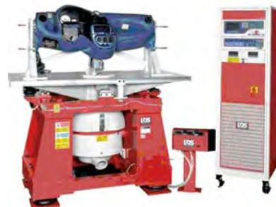
เป็นการทดสอบความทนทาน (Endurance Test) จากการสั่นของชิ้นส่วนยานยนต์ เช่น แผงประตูข้าง เบาะนั่ง โคมไฟส่องสว่าง แบตเตอรี่ เครื่องยนต์ไฮบริดจ์ สำหรับการควบคุมคุณภาพ (QA) และทดสอบการทำงาน (Function Test) ของอุปกรณ์อิเล็กทรอนิกส์และชิ้นส่วนสำคัญที่ต้องทำงานได้อย่างถูกต้อง เมื่อถูกกระตุ้นด้วยการสั่นสะเทือนหลายรูปแบบเพื่อคำนวณและพิสูจน์อายุใช้งานของแต่ละชิ้นส่วน
