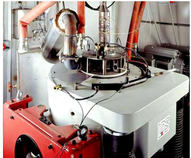
การทดสอบเสียงลั่น (เอียดอาด) และเสียงร้ว (กรอกแกรก) ที่เกิดจากการสั่น กระทบ กระพือ เสียดสี ในห้องโดยสารของรถยนต์ เช่น เสียงจากคอนโซลแผงเครื่องกล บริเวณจุดติดตั้งเครื่องเสียงและอุปกรณ์ไฟฟ้า จุดติดตั้งเบรกมือ ชุดเข็มขัดนิรภัย แผงกันแดด เบาะรถยนต์ เสียงที่เกิดจากชุดบังคับเลี้ยว เสียงที่เล็ดรอดมาจากห้องเครื่องยนต์ และระบบท่อไอเสีย เพื่อหาจุดบกพร่องในการประกอบชิ้นส่วนและแก้ไขปรับปรุง เป็นต้น
