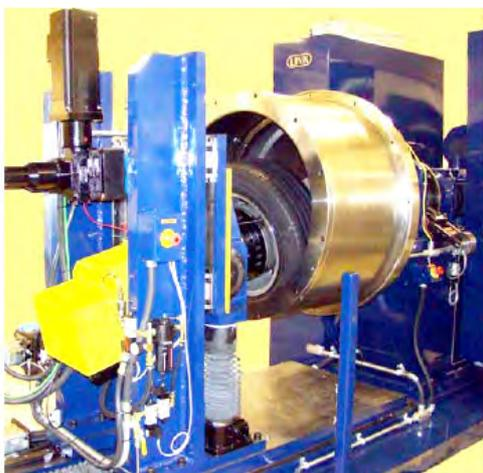
เป็นเครื่องทดสอบความทนทานของดุมและล้อรถยนต์และรถบรรทุก ตามมาตรฐาน SAEJ2562 ระบบควบคุมด้วย ProLink, Drum Diameter 970 mm or 1050 mm, Activator Load Forces Radial  $\pm 40\text{kN}$ /Lateral  $\pm 25\text{kN}$ , Drum speed 183 kph/970mm and 198 kph/1050mm
