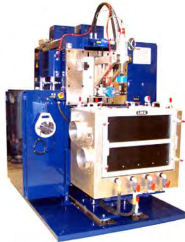
เป็นเครื่องทดสอบดุมและลูกปืนที่ใช้สำหรับรถยนต์ โดยสร้างแรงกระทำที่สภาวะแวดล้อมต่างๆ Control System ProLink, Maximum Radial Load 32,000 N, Maximum Axial Load 24,000 N, Maximum Speed 2000 rpm
