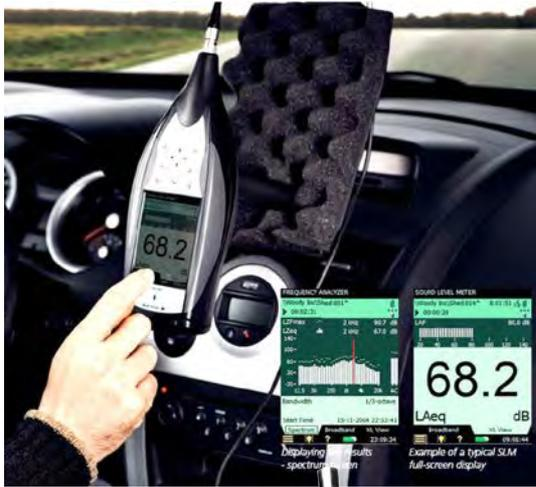
2250 เครื่องวิเคราะห์เสียงรบกวนในห้องโดยสารรถยนต์ หรือใช้วัดความดังและความถี่เสียงของชิ้นส่วนต่างๆ สามารถบันทึกเสียงจริงเพื่อเปิดฟังหลังทดสอบได้ 2250 ใช้งานง่าย เพียงกดปุ่มวัดและบันทึกข้อมูล แล้วโอนข้อมูลไปยังคอมพิวเตอร์เพื่อทำรายงานได้อย่างง่ายดาย มั่นใจได้ด้วยมาตรฐาน IEC 61672 Class 1
