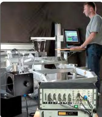
ชุดทดสอบคุณสมบัติทาง Vibration ของวัสดุและโครงสร้างต่างๆ สามารถวิเคราะห์หรือปร่าการสั่นที่ความถี่ต่างๆ ได้ง่ายและรวดเร็ว ระบบสามารถเริ่มต้นที่จำนวนหัววัดน้อยๆ เพื่องบประมาณจัดตั้งต่ำๆ และขยายระบบในอนาคตได้ภายหลัง
