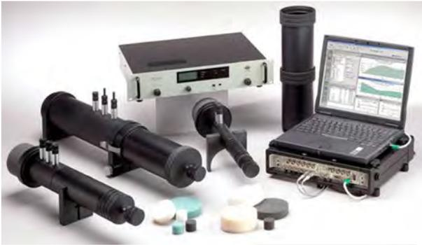
ชุดทดสอบคุณสมบัติการดูดกลืนเสียงของวัสดุต่างๆ เช่น การดูดกลืนเสียง การสะท้อนเสียง การยอมให้เสียงผ่านทะลุ ฯลฯ ของวัสดุต่างๆ ที่ใช้ในห้องเครื่องห้องโดยสาร ครอบคลุมย่านความถี่ทดสอบ 50Hz-6400Hz ราคาถูกกว่าสร้างห้องทดสอบเสียงหลายเท่า แต่ยังคงคุณภาพของผลการทดสอบตามมาตรฐานนานาชาติ ISO 10532-2 และ ASTM E-1050 เป็นระบบอัตโนมัติ ควบคุมด้วยซอฟต์แวร์บนวินโดวส์ ใช้คนเดียวก็ทดสอบจนได้เอกสารรายงานผลภายในเวลาไม่กี่นาที
