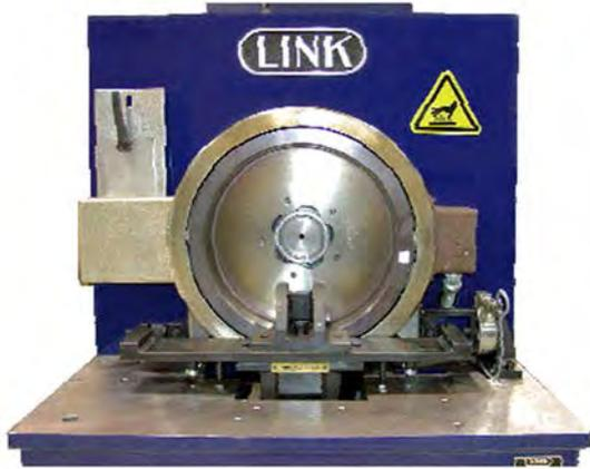
เป็นเครื่องทดสอบคุณสมบัติของผ้าเบรกและผ้าคลัตช์ของรถยนต์ สำหรับงานตรวจสอบคุณภาพ (QA) และงานพัฒนา (R&D) รวมทั้งเครื่องสามารถทดสอบคุณสมบัติของวัสดุตามมาตรฐาน SAEJ651 ได้ด้วย
