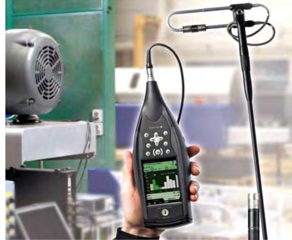
2270 และ Intensity Probe เป็นชุดเครื่องมือหาแหล่งกำเนิดเสียงแบบมือถือ ที่ช่วยแก้ปัญหาเรื่องเสียงได้อย่างรวดเร็ว วัด Sound Intensity ตามมาตรฐาน IEC 61043, แสดงเสียงแบบแยกความถี่ตั้งแต่ 50 Hz ถึง 10 KHz, สามารถบอกทิศทางของเสียง, ทำแผนที่เสียงเพื่อเปรียบเทียบ, มีกล้องดิจิทัลในตัว ถ่ายรูปภาพเพื่อซ่อนภาพความดังเสียงได้
