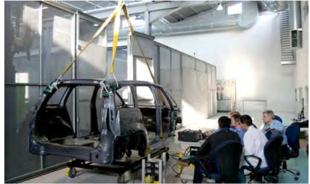
หลัง มีซอฟต์แวร์ Post Processing รองรับอย่างกว้างขวางเหมาะสำหรับห้องทดสอบที่ต้องทำการ Validation Vibration Property ของชิ้นส่วนต่างๆ กับ Model ที่ออกแบบไว้ใน Finite Element Software เพื่อเพิ่มความถูกต้องของการ Simulate พฤติกรรม Vibration ที่เปลี่ยนแปลงไปเมื่อทำการ Modify Structure ใน Finite Element Software
