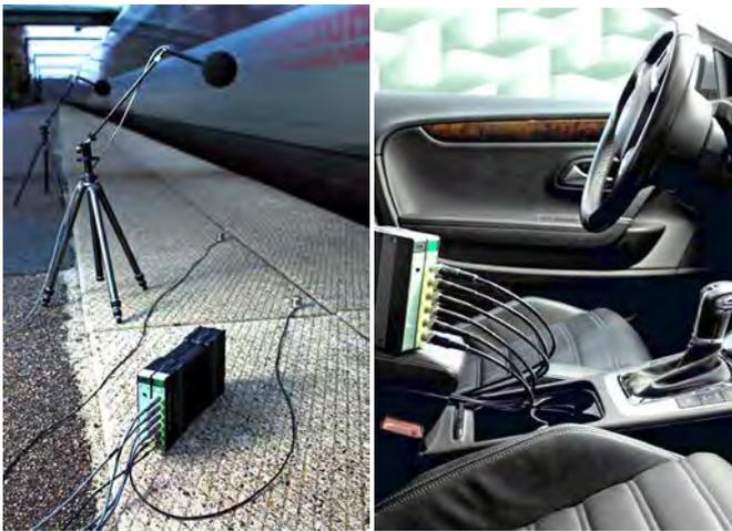
NOTAR เป็นเครื่องวัดและบันทึกข้อมูลเสียงและการสั่นสะเทือนแบบ Stand-Alone Data Acquisition Unit ขนาด 51.2 kHz 6 แชนเนล ขยายเพิ่มได้ในอนาคต สำหรับงานภาคสนาม พร้อมบันทึก Time Waveform Data ของทุกแชนเนลลงในหน่วยความจำแบบ SD Card ในตัวเป็นไฟล์ .wav แล้วนำข้อมูลมาวิเคราะห์ภายหลังด้วยซอฟต์แวร์ PULSE REFLEX หรือซอฟต์แวร์ใดๆ ที่รู้จักไฟล์ .wav ซึ่งทำให้สามารถใช้บันทึกในยานพาหนะต่างๆ ขณะเคลื่อนที่โดยไม่มีสายพ่วงรุงรัง หรือต้องระวังการกระทบกระแทกเมื่อใช้ร่วมกับคอมพิวเตอร์อีกต่อไป
