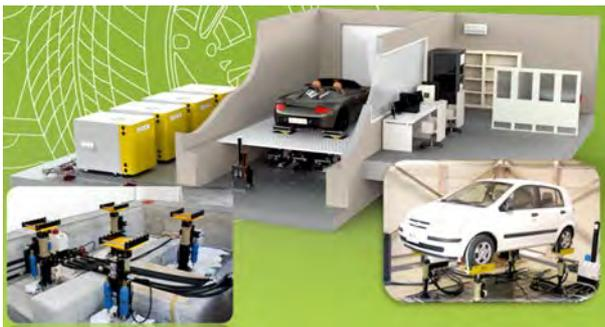
เครื่องทดสอบความสั่นสะเทือนสำหรับรถยนต์ทั้งคันที่ประกอบเสร็จสมบูรณ์ สามารถจำลองสภาพความสั่นสะเทือนที่เกิดจากการขับขี่ได้หลากหลายรูปแบบ เช่น การขับขี่ในเมือง การขับขี่ความเร็วสูง หรือการขับขี่แบบ Off-Road ระบบทดสอบสามารถปรับระยะความกว้างและความยาวตามขนาดของรถได้ มีความแม่นยำ และประสิทธิภาพสูง
