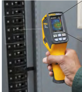
มีเคอร์เซอร์อ่านค่าอุณหภูมิที่กึ่งกลางจอภาพอย่างแม่นยำ
