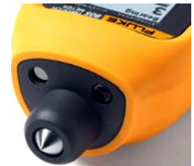
ไพเอโซวัตต์ สัมผัสหัววัดกับตัวเครื่องจักรให้ใกล้แบริ่งที่สุด ออกแรงกดจนไพเอโซวัตต์ ไพเอโซวัตต์ การวัดค่าเสริ่งสั้นสมบูรณ์ ไพเอโซวัตต์ เกิดข้อผิดพลาด แรงกดไม่พอหรือเวลาสั้นไป ไม่มีการวัดค่า
