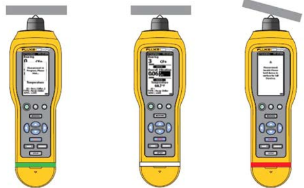
ไพเอโซวัตต์ สัมผัสหัววัดกับตัวเครื่องจักรให้ใกล้แบริ่งที่สุด ออกแรงกดจนไพเอโซวัตต์ ไพเอโซวัตต์ การวัดค่าเสริ่งสั้นสมบูรณ์ ไพเอโซวัตต์ เกิดข้อผิดพลาด แรงกดไม่พอหรือเวลาสั้นไป ไม่มีการวัดค่า
