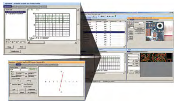
ซอฟต์แวร์ Huntron Workstation สำหรับสร้าง Test Routine, จัดเก็บ Signature และเรียกดูโดยสะดวก
