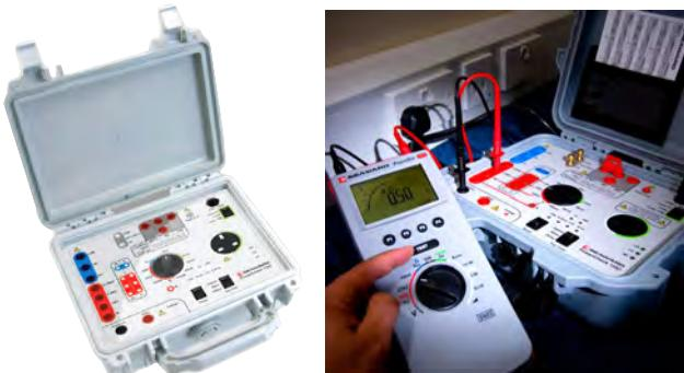
เป็นเครื่องตรวจสอบงานการทำงานของเครื่องทดสอบตามมาตรฐาน BS 7671 / EN 61157 และมาตรฐานอื่นๆ ทุกด้วยตัวเครื่องหนาแน่นสูง ใช้ตรวจสอบค่ามาตรฐานเหล่านี้
