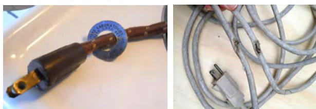
การตรวจสอบด้วยสายตา มีความสำคัญเป็นอย่างยิ่ง โดยเฉพาะสภาพเครื่องใช้ไฟฟ้า สายไฟ ปลั๊กไฟ เต้ารับที่ใช้งานร่วมกัน หากไม่ดูในสภาพที่ปลอดภัยต้องรับทำการแก้ไข
