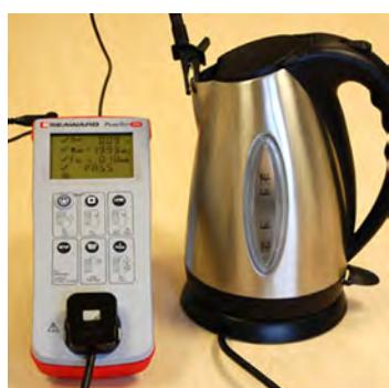
การทดสอบกำลังไฟฟ้าใช้งาน (Function Test) เป็นการวัดค่ากำลังไฟฟ้าที่ใช้งานเทียบกับป้ายแสดงที่ระบุไว้ หากเครื่องใช้ไฟฟ้าใช้กำลังไฟฟ้าผิดปกติ ต้องได้รับการแก้ไขหรือหยุดการใช้งาน
