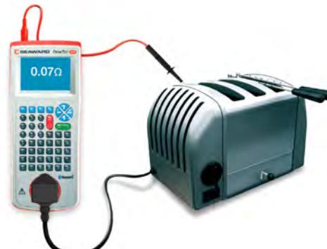
การทดสอบการต่อเชื่อมของสายกราวด์ (Earth Continuity Test) เป็นการตรวจดูคุณสมบัติของสายกราวด์ว่าต่ออยู่หรือไม่ และแข็งแรงพอที่จะป้องกันกระแสไฟฟ้ารั่ว ค่าความต้านทานไม่ควรเกิน  $0.1 \Omega$  ถ้าค่าความต้านทานสูงเกินไปจะต้องรับทำการแก้ไขหรือหยุดใช้งาน
