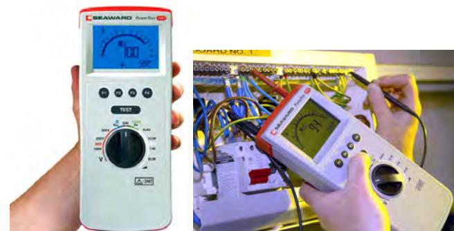
เป็นเครื่องทดสอบหลายหน้าที่ สำหรับงานติดตั้งไฟฟ้า ให้เป็นไปตามมาตรฐานงาน BS7671 (17th Edition) แบบมือถือ มีพร้อมติดตั้งในตัว ช่วยให้ทำงานได้สะดวกและปลอดภัย วัดค่าได้รวดเร็วใน 5 วินาที ทดสอบ RCD ได้ตั้งแต่มีตัวและวัดค่าอื่นๆ ดังนี้
