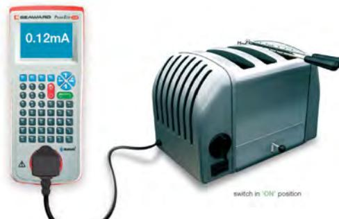
การทดสอบกระแสไฟฟ้ารั่ว (Protective Conductor Current/Leakage) เป็นค่าที่ต้องวัดและเทียบกับมาตรฐาน หากกระแสไฟฟ้ารั่วเกิน 3.5 mA ต้องหยุดการใช้งานและรีบแก้ไข
