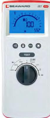
เป็นเครื่องวัดความต้านทานในงานติดตั้งไฟฟ้า วัดความต้านทานจนกว่าได้  $0.001\text{ M}\Omega$  -  $2000\text{ M}\Omega$  ความต้านทานต่ำ  $0\ \Omega$  -  $2\ \Omega$  และ  $0\ \Omega$  -  $2000\ \Omega$  วัดความต่อเนื่องด้วยเสียง “บีบ” ที่ความต้านทานต่ำกว่า  $30\ \Omega$
