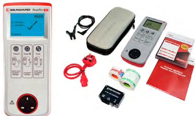
เป็นเครื่องที่สามารถทดสอบพื้นฐานความปลอดภัยของเครื่องใช้ไฟฟ้าได้ ดังนี้ สามารถใช้เครื่องนี้ทดสอบหน้างานได้ถ้าตรวจสอบแล้วพบว่ามีความเสี่ยงเรื่องความปลอดภัย ให้สำหรับทดสอบเครื่องใช้ไฟฟ้าที่เป็น Class I
