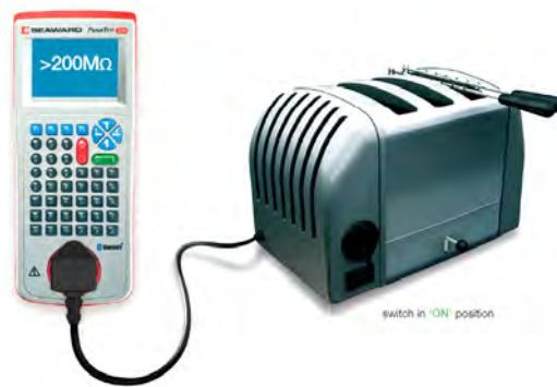
การทดสอบความต้านทานฉนวน (Insulation Resistance) ค่าความต้านทานฉนวนจะมีความสำคัญหากต่ำเกินไป กระแสไฟฟ้ารั่วจะมากขึ้น ค่าความต้านทานไม่ควรต่ำกว่า  $1 \text{ M}\Omega$
