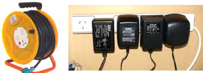
สายต่อพ่วงก็มีความสำคัญไม่น้อย หากมีการนำมาใช้โดยเฉพาะความยาวสาย ขนาดของสาย ต้องสัมพันธ์กับกระแสไฟฟ้าที่เครื่องใช้ไฟฟ้าต้องการ การทดสอบทำเช่นเดียวกัน ได้แก่
