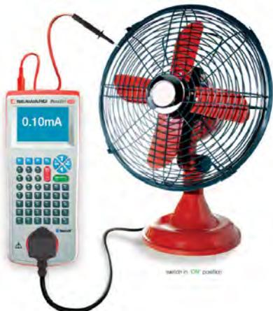
การทดสอบกระแสไฟฟ้ารั่ว (Touch Current) ค่ากระแสไฟฟ้ารั่วไม่ควรสูงกว่า 0.25 mA
