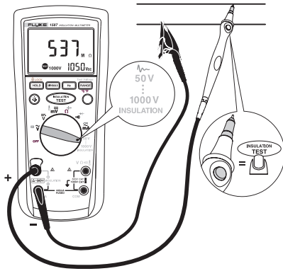
การทดสอบฉนวนไฟฟ้า
