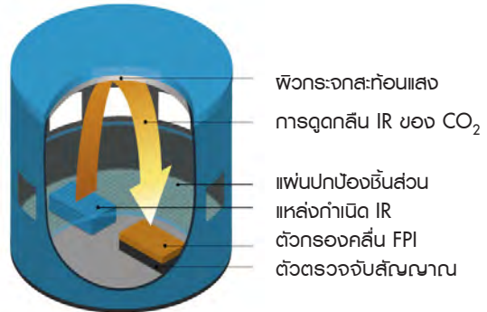
โครงสร้างของ Vaisala CARBOCAP® Sensor ช่วยให้ได้สมรรถนะดีเยี่ยม เชื่อถือได้ยาวนาน
