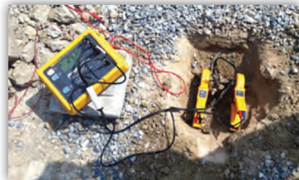
FLUKE 1625-II วัดความต้านทานบอบหลายกราวด์ที่ต่อจากหลักดินแยกไปเชื่อมกับระบบหลายกราวด์ที่โครงแบบเซลล์แสงอาทิตย์
