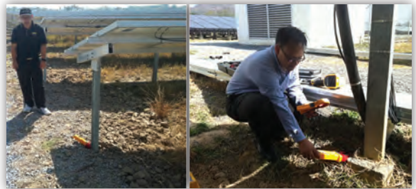
FLUKE 1630 ตรวจสอบความต่อเนื่องบอบหลายกราวด์ที่ใช้ฐานเบา
