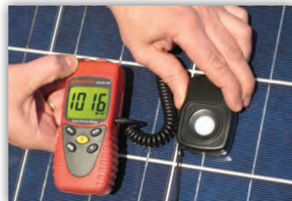
เครื่องตรวจวัดพลังงานแสงอาทิตย์ (Solar-100) ที่ใช้คู่กับ Solar 600
