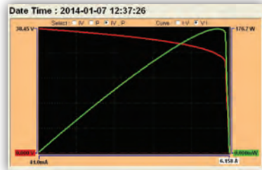
คุณสมบัติของเซลล์แสงอาทิตย์ที่ปกติ
