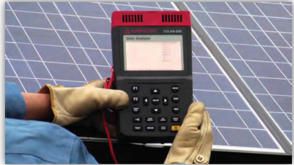
การตรวจวัดคุณสมบัติของเซลล์แสงอาทิตย์ที่เสียหาย
