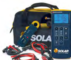
Seaward PV 150 ตรวจวัดคุณสมบัติของแผงโซลาร์เซลล์ วัด Insulation, Voc, Isc, Power
