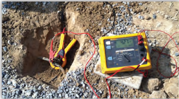
FLUKE 1625-II ตรวจวัดประสิทธิภาพแต่ละกิตินในสถานีไฟฟ้าพลังงานแสงอาทิตย์
