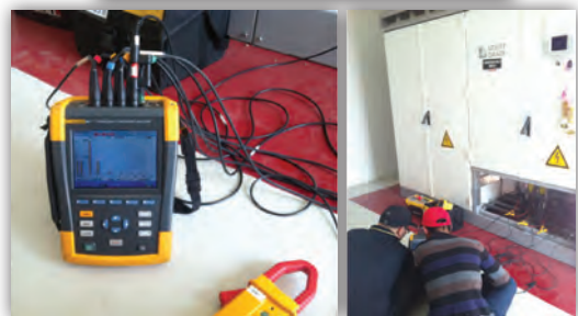
Fluke 435-II มีฟังก์ชันที่วัดประสิทธิภาพและคุณภาพทางไฟฟ้า
