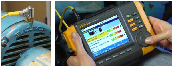
รูปที่ 9 การติดตั้งเซ็นเซอร์ที่ตำแหน่งแบริ่ง และการวินิจฉัย ความผิดปกติโดยอัตโนมัติ
