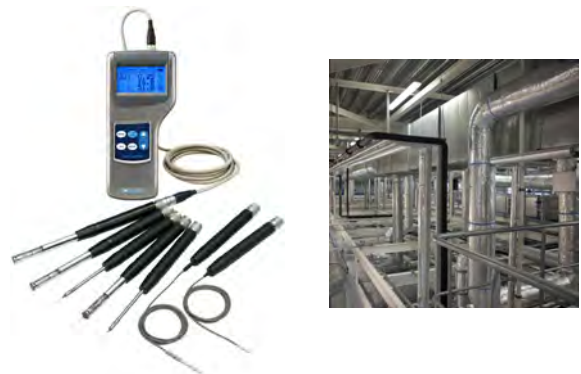
รูปที่ 18 Kanomax 6501 วัดได้ทั้งความเร็วลม, อุณหภูมิ และความชื้น
