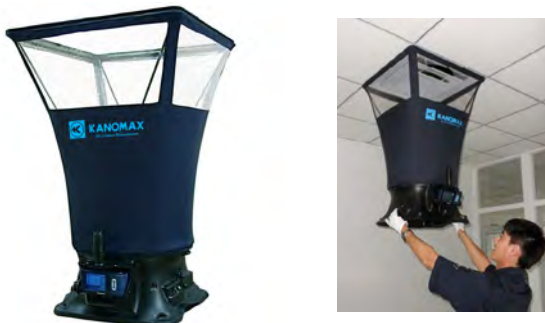
รูปที่ 16 การวัดปริมาณลมที่หัวจ่ายแอร์ด้วย Kanomax6710
