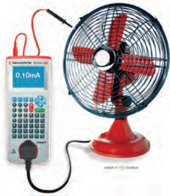
การทดสอบกระแสไฟฟ้ารั่วที่เปลือกนอก (Touch Current) ค่ากระแสไฟฟ้ารั่วไม่ควรสูงกว่า 0.25mA
