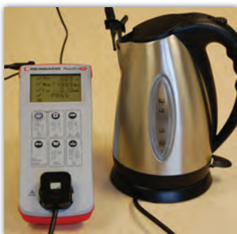
การทดสอบกำลังไฟฟ้าใช้งาน (Function Test) เป็นการวัดค่ากำลังไฟฟ้าที่ใช้งานเทียบกับป้ายแสดงที่ระบุไว้ หากเครื่องใช้ไฟฟ้าใช้กำลังไฟฟ้าผิดปกติ ต้องได้รับการแก้ไขหรือหยุดการใช้งาน
