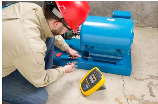
การปรับตั้งฐานยึดเครื่องจักรด้วยขิม ตามระยะที่ระบุบนหน้าจอ
