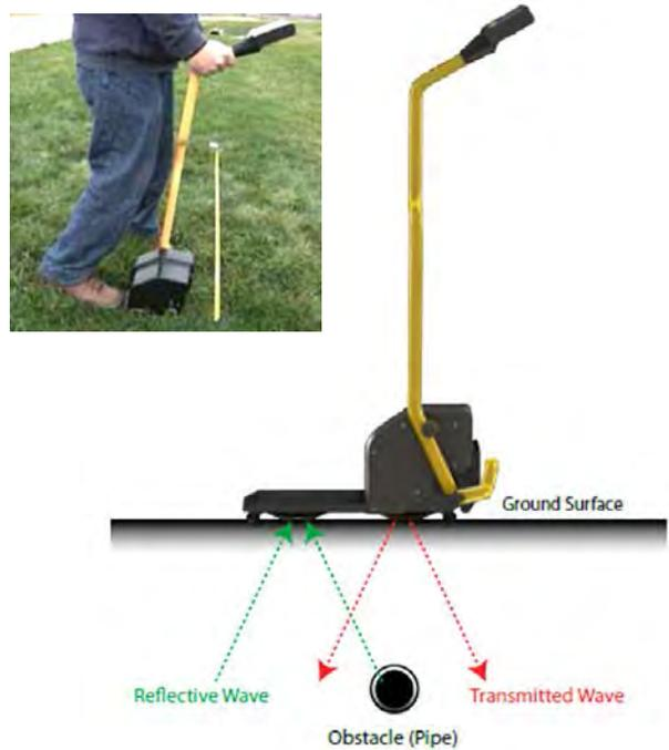
เครื่องค้นหาท่อใต้ดินที่ใช้หลักการสะท้อนคลื่นเสียง เหมาะสำหรับการค้นหาท่อพลาสติก หรือระบบท่อที่ขาดช่วง, สูญหาย หรือสายไฟที่ขาด ซึ่งการค้นหาด้วยหลักการสนามแม่เหล็กไฟฟ้าใช้ไม่ได้ ไม่ว่าจะเป็นท่อแก๊ส, ท่อประปา หรือแม้แต่ท่อน้ำทิ้งก็สามารถค้นหาได้
