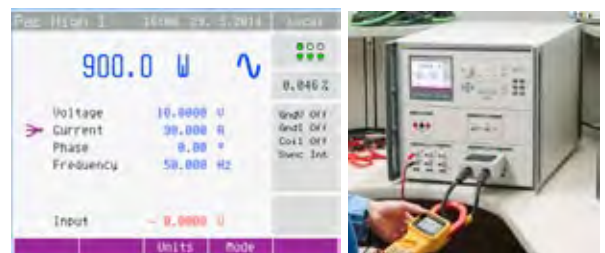
Hi Current Mode เมื่อต้องการกระแสที่สูงมากกว่า 30A ที่เฟสเดียว
