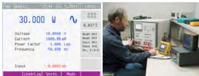
Basic Power Mode สำหรับการทดสอบทั่วไปจ่ายแรงดันและกระแสเหมือนกันทั้ง 3 เฟส
