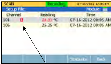
แสดงหมายเลขเอาต์พุตแจ้งเตือนแต่ละแชนเนลที่หน้าจอ
