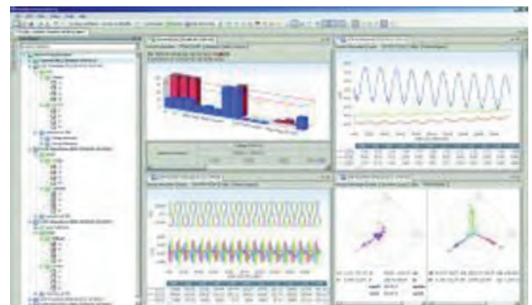
MI 2892 Power Master วัดและวิเคราะห์ค่าทางไฟฟ้า จำเป็นทุกๆ ค่าตามมาตรฐาน EN50160
