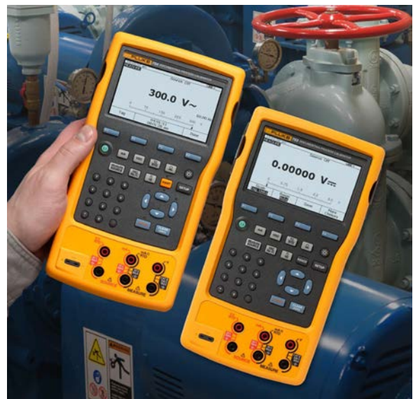
รูปที่ 9 (1) Fluke 753/754 Documenting Process Calibrator สามารถแสดงผลพร้อมกันบนจอ และรูปที่ 9 (2) สามารถคำนวณ % Error และบอกการผิดพลาดเกินกำหนดที่จุดสอบเทียบใดได้ด้วย
