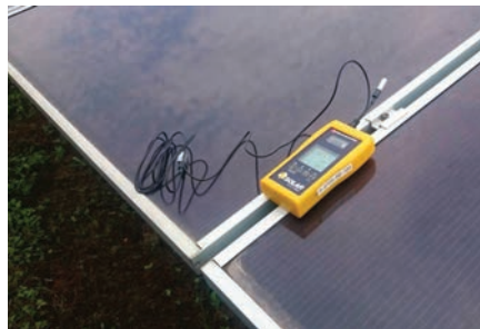
การวัดพลังงานแสงอาทิตย์ที่ตกกระทบแผงโซลาร์เซลล์
