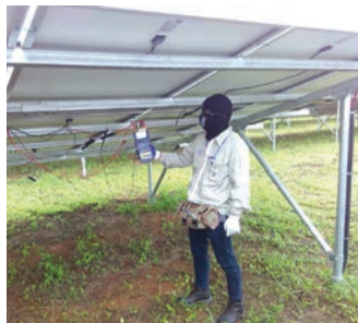
การวัดพลังงานแสงอาทิตย์ที่ตกกระทบแผงโซลาร์เซลล์
