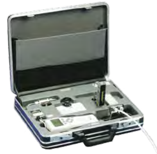
Vaisala DSS70A ชุดเก็บตัวอย่าง ที่ช่วยเพิ่มความสามารถของ Dew Point เซนเซอร์ ในการวัดค่าตามพื้นที่ในกระบวนการอุตสาหกรรม
