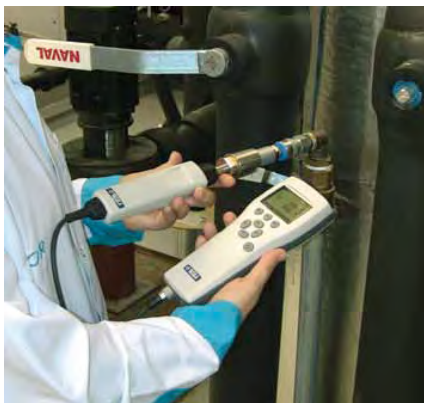
การเสียบโพรบวัด Dew Point โดยตรงผ่านบอลวาล์ว
