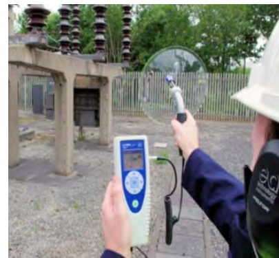
ไมโครโฟนพาราโบลิก สำหรับตรวจวัดระยะไกล
