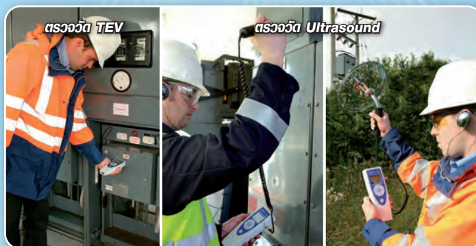
เครื่องตรวจ PD แบบพกพา ใช้ประเมินความรุนแรง ด้วยการตรวจวัด Transient Earth Voltage และ Ultrasound
