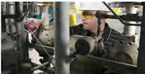
Fluke 1551A Ex/1552A Ex Digital "Stick" Thermometer สำหรับงานสอบเทียบอุณหภูมิในพื้นที่ ไวต่อประกายไฟ (intrinsically safe)
