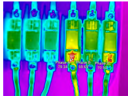
ภาพความร้อนที่จุดเชื่อมต่อหลวม
