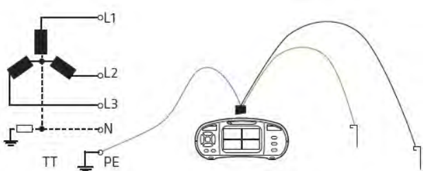
แบบ 3 สาย (ต่อสายวัดกับแท่งหลักดินเป็น 3 เหลี่ยม)
