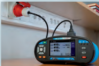
วัดแรงดัน 1 เฟส และ 3 เฟส พร้อมแสดงลำดับเฟส
