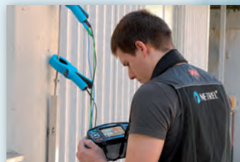
ตรวจวัดความต้านทานดินได้ ทั้งแบบ Clamp และ Ground Rod
