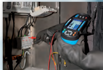
วัดฉนวนไฟฟ้าสูงสุด 1000V/999MΩ
