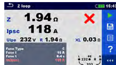
ตัวอย่างผลการวัดที่ให้ค่า Loop Impedance ที่สูง และค่า Ipsc ต่ำกว่าปกติการตัดวงจรของอุปกรณ์ชนิด Fuse ในระบบ
