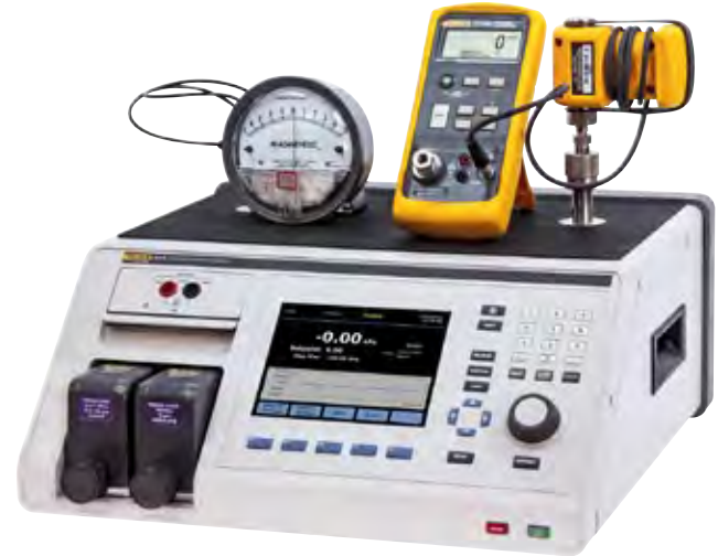
Fluke 2271A สอบเทียบอุปกรณ์วัดความดันได้หลากหลาย
