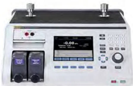
Fluke 2271A ติดตั้งโมดูลรุ่น PM200 จากด้านหลังได้พร้อมกัน 2 โมดูล
