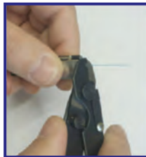
ปอกเปลือกหุ้ม สายไฟเบอร์
