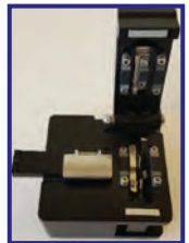
ใช้ตัวยึดสายและ ตัดปลาย
