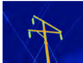
เสาไฟฟ้าแรงสูง ถ่ายด้วยกล้อง Fluke TiX560 เลนส์มาตรฐาน
