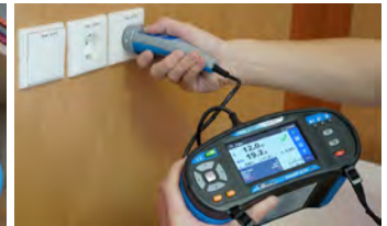
วัด Loop Impedance พร้อมแสดงผล Pass/Fail ตามมาตรฐาน IEC60264, BS7671
