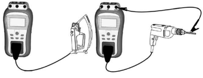
การเชื่อมต่อสายในการวัด กรณี Class I
