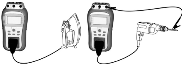
การเชื่อมต่อสายในการวัด กรณี Class I
