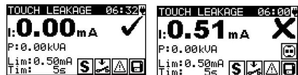
หน้าจอแสดงผลการวัดและปริมาณ กระแสไฟฟ้ารั่วไหลที่เกิดขึ้นบนพื้นผิว
