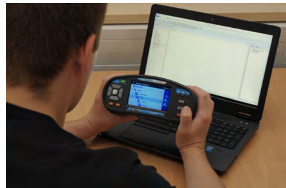
แสดงคำแนะนำการทดสอบการติดตั้งไฟฟ้าแรงดันต่ำตามมาตรฐาน IEC 60364-6
