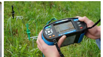
ตรวจวัดความต้านทานดินได้ ทั้งแบบ Clamp และ Ground Rod
