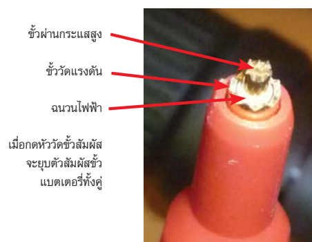
โพรบวัด Kelvin มีขั้วสัมผัส 2 ชั้น สำหรับกระแสและแรงดันแยกจากกัน
