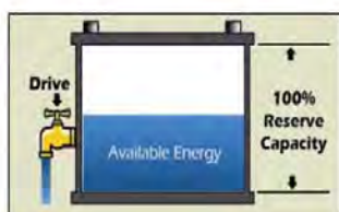
ระดับที่ 1 ซัลเฟตตกค้างเล็กน้อย ไม่มีผลต่อความจุของแบตเตอรี่
