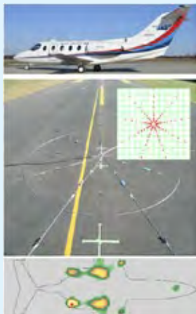
รูปที่ 6 การใช้ไมโครโฟนอาร์เรย์ช่วยให้ทราบตำแหน่งการเกิดเสียงรบกวนของเครื่องบินที่เฉพาะเจาะจงได้
