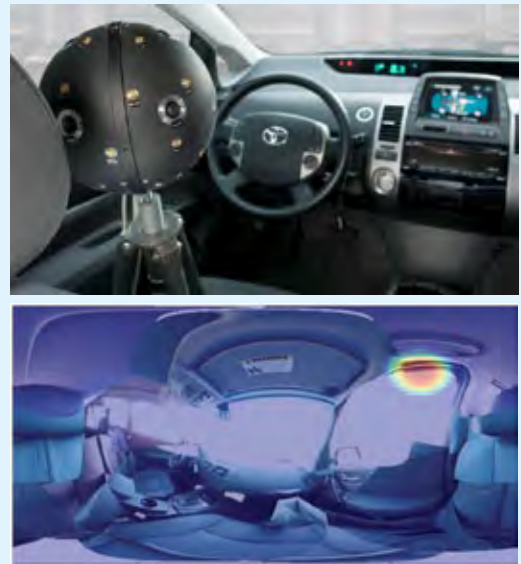
รูปที่ 18 Type 8606 Spherical Microphone Array และการทำงานในการระบุแหล่งกำเนิดเสียงในห้องโดยสารรถยนต์
