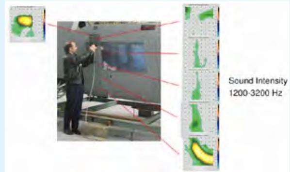
รูปที่ 15 การใช้ไมโครโฟนอาร์เรย์ตรวจวัด Sound Intensity ด้วยเทคนิค NAH
