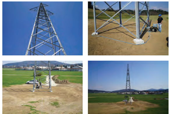
ทดสอบความต้านทานระบบกราวด์ของอุปกรณ์ลงดินหลัก
