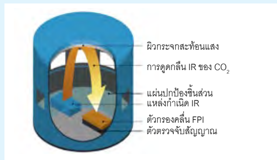
โครงสร้างของ Vaisala CARBOCAP® Sensor ช่วยให้ได้สมรรถนะดีเยี่ยม เชื่อถือได้ยาวนาน
