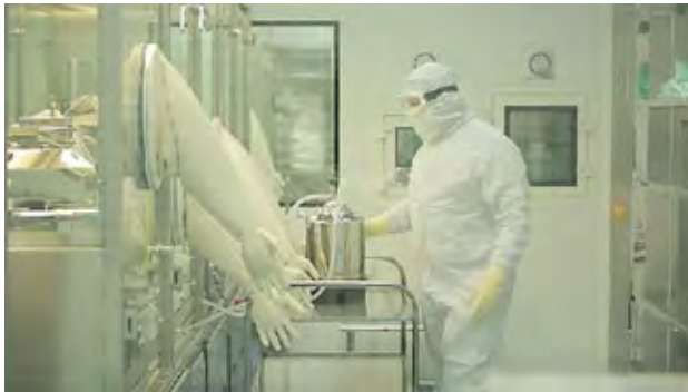
การใช้ตู้ปลอดเชื้อในโรงงานยา มีการใช้ H_2O_2 ในตู้ดังกล่าว
