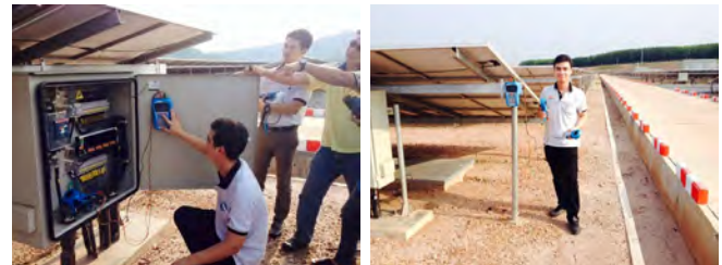
การวัดระบบกราวด์ที่แผงโซลาร์เซลล์
