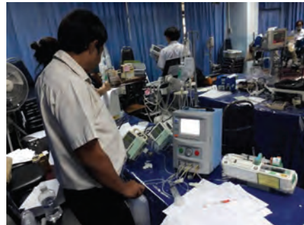
Rigel Multiflo กับการทดสอบเครื่องควบคุมการให้สารละลายทางหลอดเลือดแบบ syringe สามารถควบคุมแบบ Remote ผ่านคอมพิวเตอร์
