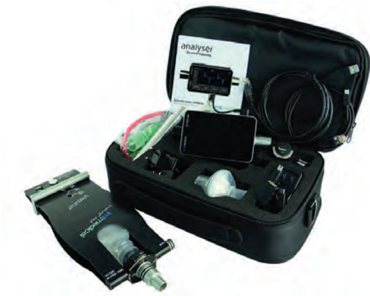
CITREX H5 Set มาพร้อม FlowLab Software สำหรับทดสอบและทำรายงาน มีกระเป๋านำใส่เครื่องและอุปกรณ์พร้อมใช้งานภาคสนาม
