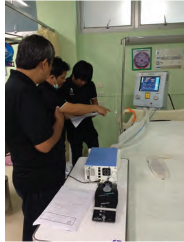
Imtmedical รุ่น PF300V กับการทดสอบเครื่องช่วยหายใจ
