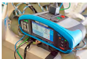
ตรวจวัดกระแสรั่วไหล ทดสอบ การทำงานของเครื่องตัดไฟรั่ว
