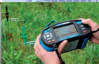
ตรวจวัดความต้านทานดินได้ ทั้งแบบ Clamp และ Ground Rod
