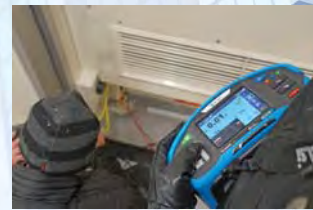
วัดความถี่ไฟฟ้าสูงสุด 1000V/999MΩ
