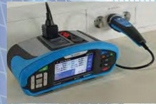
วัด Loop Impedance พร้อมแสดงผล Pass/Fail ตามมาตรฐาน IEC60264, BS7671
