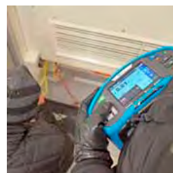
วัดฉนวนไฟฟ้าสูงสุด 2,500V/999MΩ
