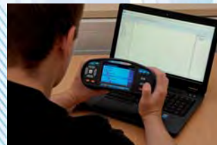
Auto Test Sequence โปรแกรมลำดับการทดสอบได้ล่วงหน้าแบบอัตโนมัติ
