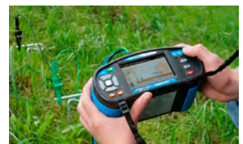
ตรวจวัดความต้านทานดินได้ ทั้งแบบ Clamp และ Ground Rod
