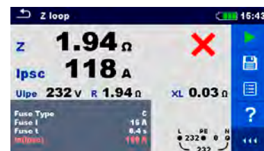
ตัวอย่างผลการวัดที่ไพลล์ Loop Impedance ที่สูง และค่า Ipssc ต่ำกว่าปกติการตัดวงจรของอุปกรณ์ชนิด Fuse ในระบบ
