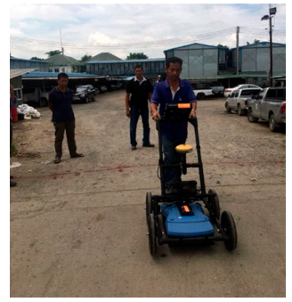
ภาพตัวอย่าง การเดินสำรวจแบบ Line Scan เพื่อตรวจสอบวัตถุที่อยู่ใต้ดิน
