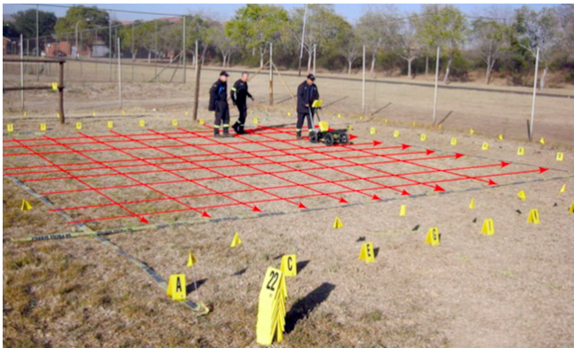
ภาพตัวอย่าง การเซ็นเครื่อง GPR แบบ Grid Scan
