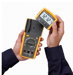
(3) แบบถอดแยกภาคแสดงกับภาควัดออกจากกันเพื่อดูผลการวัดจากระยะไกลแบบไร้สายได้
