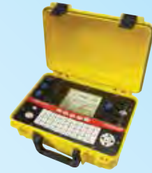
Cropico D04000 ไมโครโอห์มมิเตอร์ แบบดิจิทัล วัดได้ 4 mΩ ถึง 4 kΩ ความละเอียด 10 μΩ
