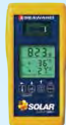
Solar Survey 200R มิเตอร์ วัดค่าพลังงาน แสงอาทิตย์ (Irradiance) เพื่อสำรวจ พื้นที่ติดตั้ง
