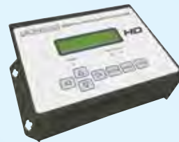
Promax EN-206 อุปกรณ์ HDTV มอดูเลเตอร์ HDMI input to DVB-T
