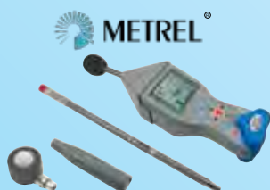
Metrel MI 6201 Multinorm เครื่องวัดสภาพแวดล้อมหลาย พารามิเตอร์และวัดเสียง
