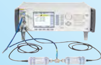
Fluke 96270A เครื่องกำเนิดความถี่ อ้างอิงชนิดเฟสน้อยสี่ ต่ำ ขนาด 27 GHz
