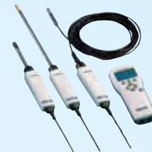
Vaisala HM70 วัดความชื้นและอุณหภูมิเฉพาะจุดแบบมือถือ เปลี่ยนโพรบได้ตามช่วงวัด
