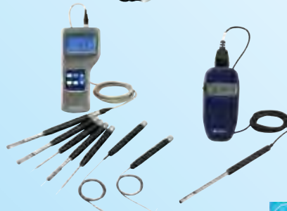
Kanomax 6501 Series เครื่องวัดความเร็วลมแบบ มัลติฟังก์ชัน ให้ความ แม่นยำสูงแม้ความเร็วลม
