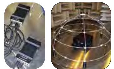
Sound Power – การวัดเสียงรบกวนในหน่วย Sound power ของผลิตภัณฑ์ให้สอดคล้อง กับ ISO 3744-5, EU Directive
