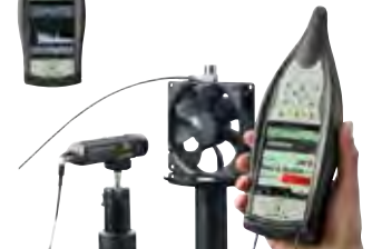
2250H เครื่องวัดและวิเคราะห์ ความสั่นสะเทือนสำหรับงาน ตรวจสอบคุณภาพสินค้า (QC)
