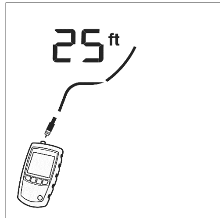
สาย Coax ขนาดที่ระยะ 25 ฟุต
